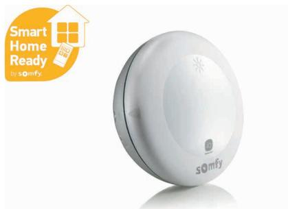
Drahtloser Sonnensensor, der direkt in io-Funkantriebe bzw. in eine bidirektionale Steuerung (Nina, Nina Timer, TaHoma) eingelernt wird. Funkantriebe erhalten Fahrbefehle sobald der Sensor ein Über- oder Unterschreiten eingestellter Helligkeitsschwellenwerte misst. Der Fahrbefehl an den Funkantrieb erfolgt entweder direkt durch den Sensor oder über die bidirektionale Steuerung.
