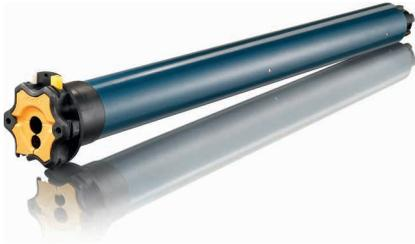
Der elektronische Antrieb ermöglicht in Verbindung mit dem animeo KNX RS485 Motor Controller den bidirektionalen Datenaustausch zwischen KNX-Bus und Antrieb. Dadurch können beliebige Zwischenpositionen programmiert oder Statusmeldungen vom Antrieb abgefragt werden.
