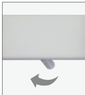
Schiene auflegen und Clip drehen
