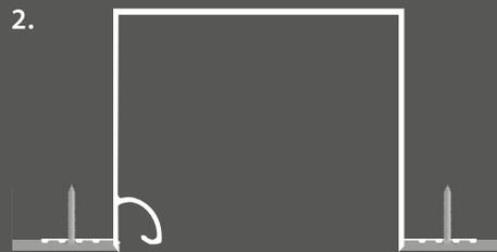
2. Die Schrauben am Montageflansch werden verspachtelt und sind somit nicht mehr sichtbar.
