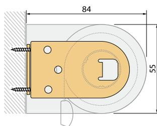
(wird optional für Rollos mit großer Höhe und großen Stoffdicken eingesetzt)
