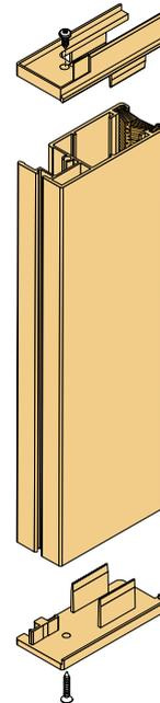
Rückansicht: Befestigung mit Montageclip
