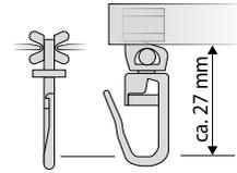
**A6 Teflongleiter mit drehbarem Faltenhaken**
