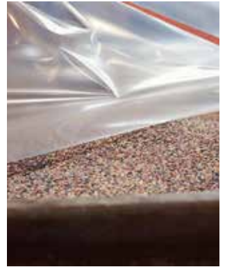
PVC-Granulat bei Tarkett in Ronneby, die Basis für iQ Surface.
