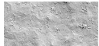
Tarkett xf 2 TM , vor Abriebtest
