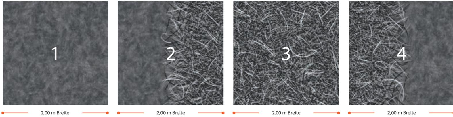
• Um einen passenden Farbverlauf zu gewährleisten, müssen alle Flotex-Bahnen in derselben Richtung verlegt werden. Stellen Sie sicher, dass die Pfeile auf der Rückseite der Bahnen in die gleiche Richtung zeigen.
