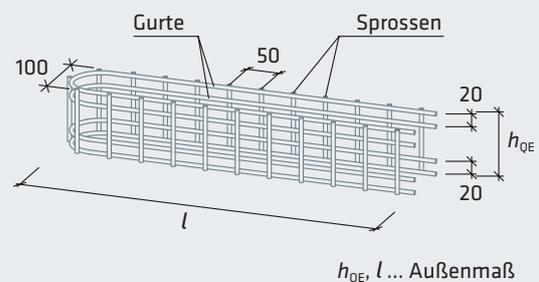
Abb. 1: Ansicht des Querkraftelementes  $Q^E$  mit Abmessungen
