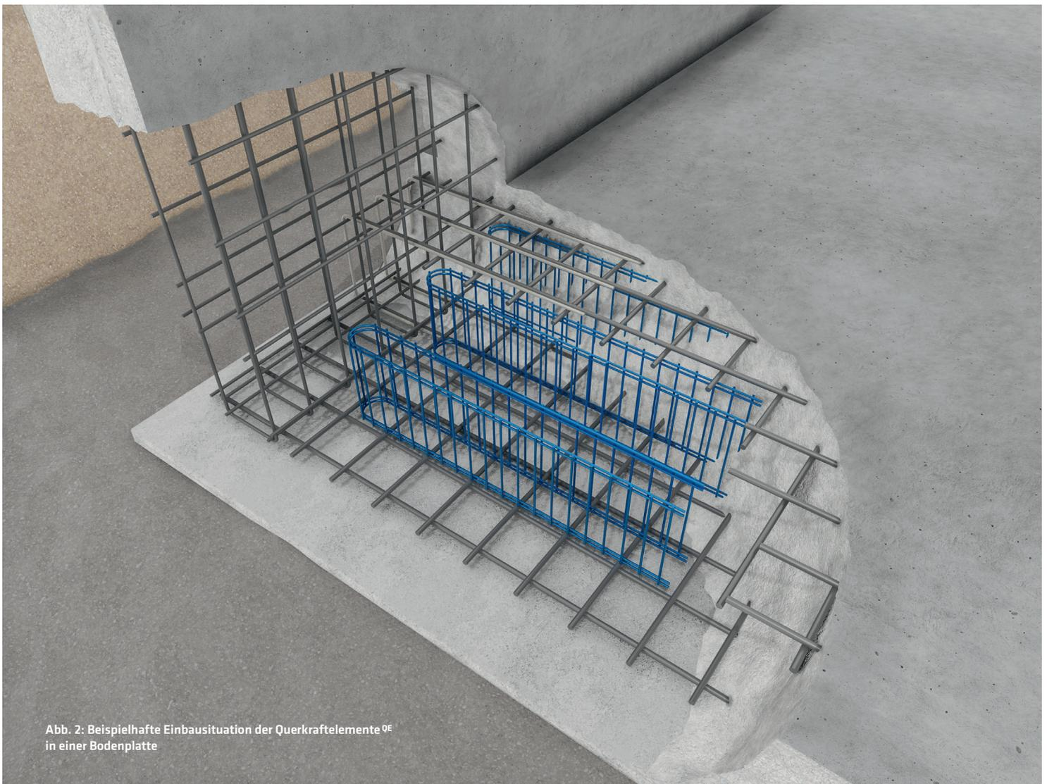
Abb. 2: Beispielhafte Einbausituation der Querkraftelemente Q<sup>E</sup> in einer Bodenplatte
