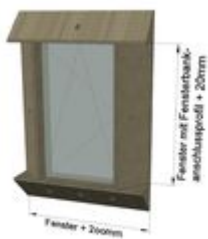
Bild 4: Maße Zuschnitt Zarge für 10 mm Fuge
