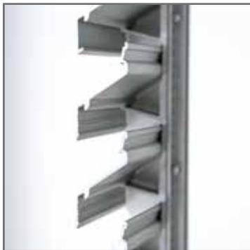
Aluminium Strangpressprofil mit einem Lamellenabstand von 33,3 mm. Standardsystem mit einer optimalen Kombination aus Luftdurchlässigkeit und Wasserdichtigkeit.
