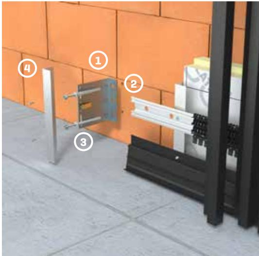
Zur Befestigung des Stützprofils und des unteren Trägers wird ein L-Profil verwendet, das an einem Profilträger befestigt ist. Die Länge des Profilträgers wird entsprechend der Dämmstoffstärke gewählt.
