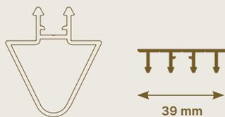
Um einen symmetrischen Abschluss (z.B. um Fenster oder Türen herum) zu ermöglichen, können Sie die Austauschprofile verwenden. Auf diese Weise endet die Wand beidseitig mit einer hohen oder einer niedrigen Seite des Profils
