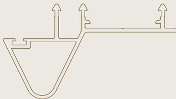
Linarte Cone-Ausgleichprofile können auch für Anschlüsse an Türen oder Toren verwendet werden und sind bei Bedarf mit einem Dichtungsgummi versehen.
