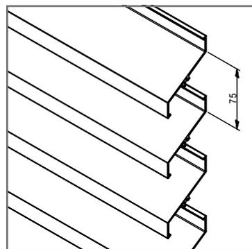
Aluminium-Strangpressprofil mit einem minimalen Luftströmungswiderstand. Diese Profile sind ideal dazu geeignet, wenn ein großer Luftdurchlass und eine große Wetterbeständigkeit erforderlich ist. Angemessene Lösung für die Luftabfuhr.
