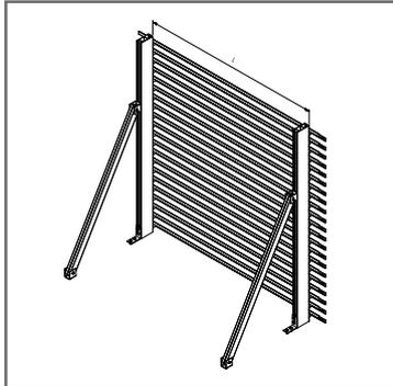
Dieses System dient zur Konstruktion freistehender Lamellenwandssysteme mit begrenzten Abmessungen und/oder Windbelastungen, bei denen eine selbsttragende Aluminium-Unterkonstruktion eine zusätzliche primäre Stahlstruktur überflüssig macht.
