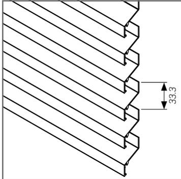
Aluminium-Strangpressprofil mit großem Durchlass
