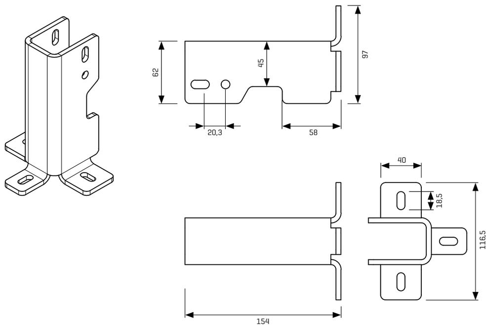
L-förmiges Befestigungselement Typ LZ.4203 und LZ.4209
