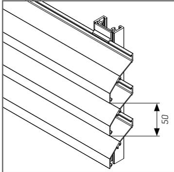
Aluminium-Strangpressprofil mit einem Standard-Lamellenabstand von 50 mm. Variable Lamellenabstände zwischen 50 und 100 mm sind mit Lamellenhalter Typ L.050.13 und L.050.14 möglich.
