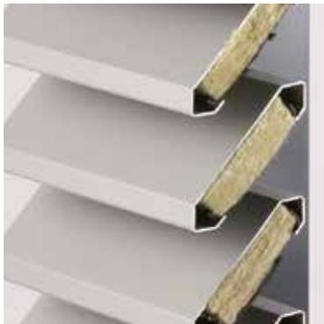
Aluminium-Strangpressprofil mit einem Lamellenabstand von 60 mm und perforierter Unterplatte. Die Höchstlänge der Lamellen beträgt 6000 mm. Um Schalldämmung zu ermöglichen, werden die Lamellen mit anorganischer Mineralwolle gefüllt. Entwickelt, um bei einem Lamellenwandsystem, bei dem die schalldämmenden Faktoren überwiegen, eine ästhetische Lösung zu bieten.
