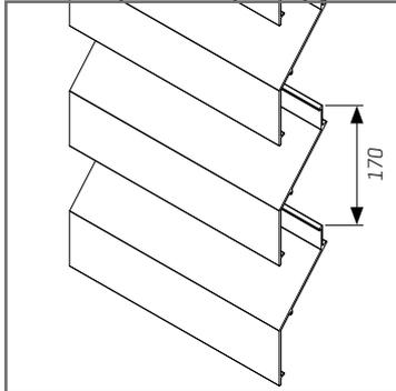
Aluminium-Strangpressprofil mit einem Lamellenabstand von 170 mm [\*], gemäß dem akustischen System. Die Lamellen sind perfekt mit den schalldämmenden Lamellen L.170ACS.01/L.170ACL.01 kombinierbar, insbesondere an Stellen in der Fassade, wo keine Schalldämmung erforderlich ist.
