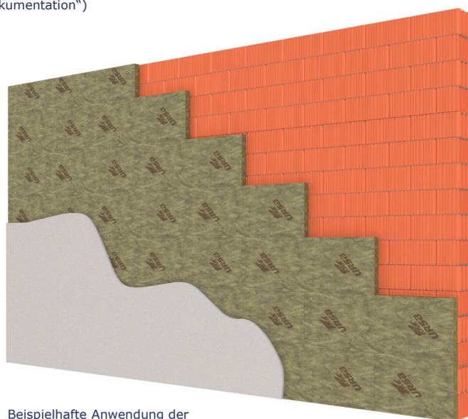
Beispielhafte Anwendung der URSA TECTONIC FP Basic Vorsatzschalendämmplatte: Klebmontage auf Ziegelmauerwerk, mit armiertem Gipsputz beschichtet
