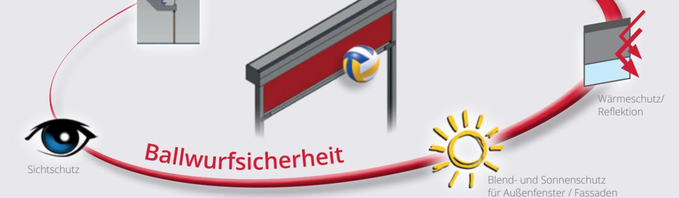
Zertifizierte ballwurfsichere Anlagen als Textile Blendschutz-, Sonnenschutz- und Verdunkelungssysteme in Sport- und Mehrzweckhallen gemäß DIN EN ISO 18032-3. Brichta bietet vier zertifizierte Montagesysteme für ballwurfsichere Anlagen, die neben dem textilen Sonnenschutz auch als Raumteiler und Abtrennungen eingesetzt werden können.
