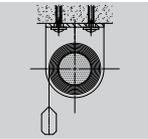
Für die Befestigung der offenen Rollo-Anlagen an Wand oder Decke dienen Universalträger.
