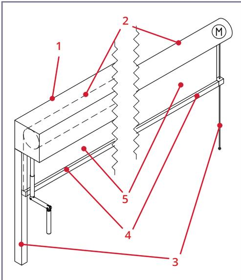
Eine ideale Möglichkeit für den Wärme-, Sonnen- und Blendschutz sind die Rollos von Brichta. Diese passen sich durch ihre Form und Farbgestaltung hervorragend an das moderne Design und die aktuelle Architektur an. Das technisch ausgereifte System ist mit einer Rollo-Welle als **Getriebekurbel-** oder **Motor-Bedienung** bestückt, auf die sich der Stoff ideal aufwickelt. Die Anlagen bieten höchsten Komfort und zahlreiche Einsatzmöglichkeiten.
