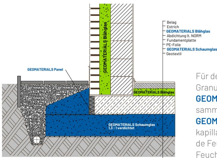
Für den Sockelbereich wird **GEOMATERIALS Blähglas** Granulat in der Körnung 2-4 mm empfohlen. **GEOMATERIALS Blähglas** schützt vor Wasserrückhaltungen in der Luftschicht im Sockelbereich. **GEOMATERIALS Blähglas** ist feuchteresistent und kapillarbrechend und schützt somit gegen aufsteigende Feuchtigkeit. Die obere Dämmung bleibt trocken, Feuchtigkeitsschäden können nicht entstehen.
