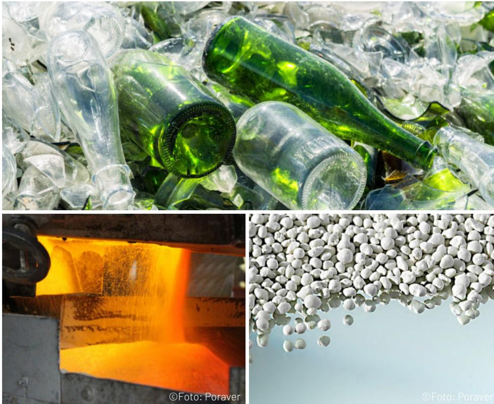
Der Rohstoff für **GEOMATERIALS Blähglas** ist Altglas. Dieser wertvolle Sekundärrohstoff wird über Sammelsysteme wiederaufbereitet.
