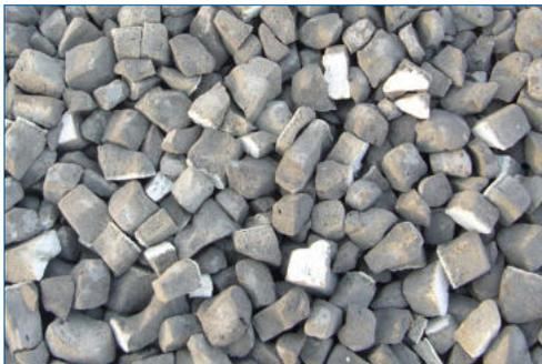
**GEOMATERIALS Schaumglas** - Die optimale lastabtragende Dämmung unter der Bodenplatte.
