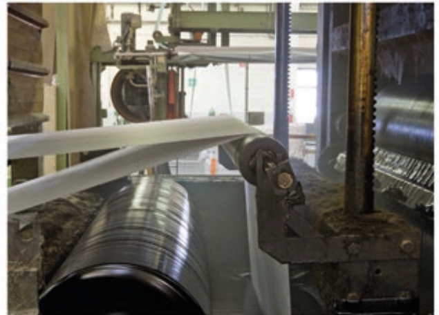
Die beiden Trägereinlagen werden in die Imprägnier- und dann in die Beschichtungspfanne geführt.
