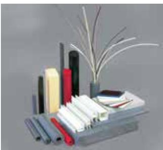
**senodur® PVC** ist ein thermoplastischer Kunststoff mit einem Temperatureinsatzbereich von 0° bis +60°C. Er besitzt hohe Festigkeit, Steifigkeit, Härte und sehr gute chemische Beständigkeit. Das Material kann verklebt und verschweißt werden.
