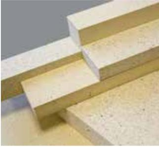
**senopur®** Platten sind ein Funktionswerkstoff aus FCKW und Formaldehydfreiem Polyurethan (PUR) Hartschaum der nachträglich verpresst wird. Sehr gute Wärmedämmeigenschaften und mechanische Festigkeit für thermische Trennungen im Baubereich. Einfach niet- und schraubbar.
