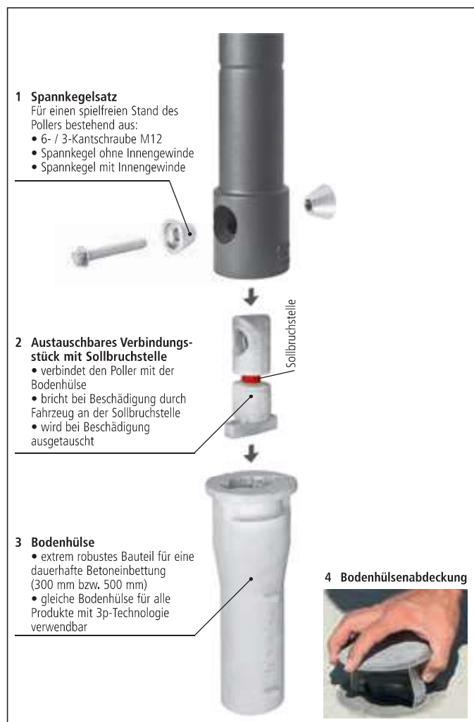
A - Spannkegelsatz im Poller lösen und herausnehmen. B - gebrochene Verbindungsstücke aus Poller und Bodenhülse entnehmen.
