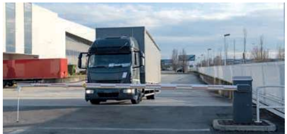
Schrankenanlage BUSSET, Absperrbreite 7,60 m mit 4 + 4 m Teleskop-Schrankenbaum mit Pendelstütze, mit LED-Schrankenbaumbeleuchtung (Zubehör)
