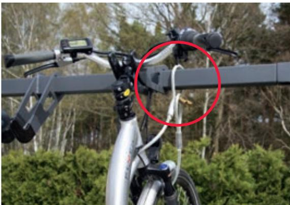
▲ Sicherungsseil zum sicheren Abschließen: durch das Vorderrad durchziehen und die Endschleife mit der Seilanfangschleife mittels bauseitigem Vorhängeschloss sichern
