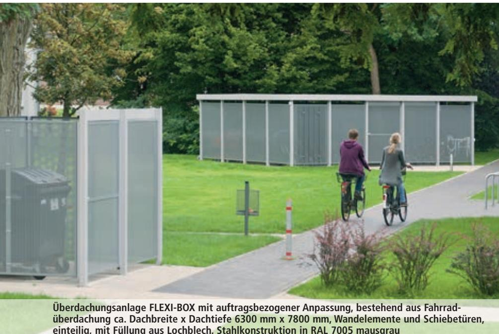
Überdachungsanlage FLEXI-BOX mit auftragsbezogener Anpassung, bestehend aus Fahrradüberdachung ca. Dachbreite x Dachtiefe 6300 mm x 7800 mm, Wandelemente und Schiebetüren, einteilig, mit Füllung aus Lochblech, Stahlkonstruktion in RAL 7005 mausgrau
