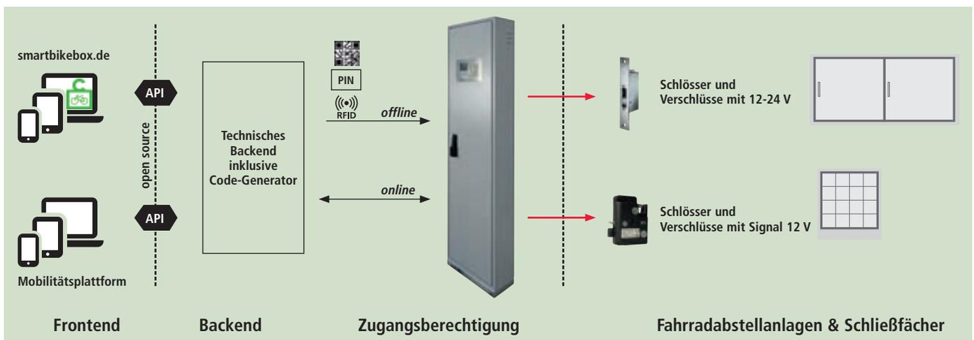
Die Internetplattform smartbikebox.de ist die Grundlage für eine intelligente Komplettlösung zur Steuerung von smarten ZIEGLER-Fahrradabstellanlagen und Schließfächern. Die Open-Source-Buchungsplattform – bestehend, aus einem Frontend zur Nutzerregistrierung, -verwaltung und zur Bezahlung – arbeitet mit einem technischen Backend der Stellplatz- und Standortverwaltung zusammen. Die Software bietet die Möglichkeit, über einen Code-Generator standortindividuelle Zugangscodes zu erzeugen.
