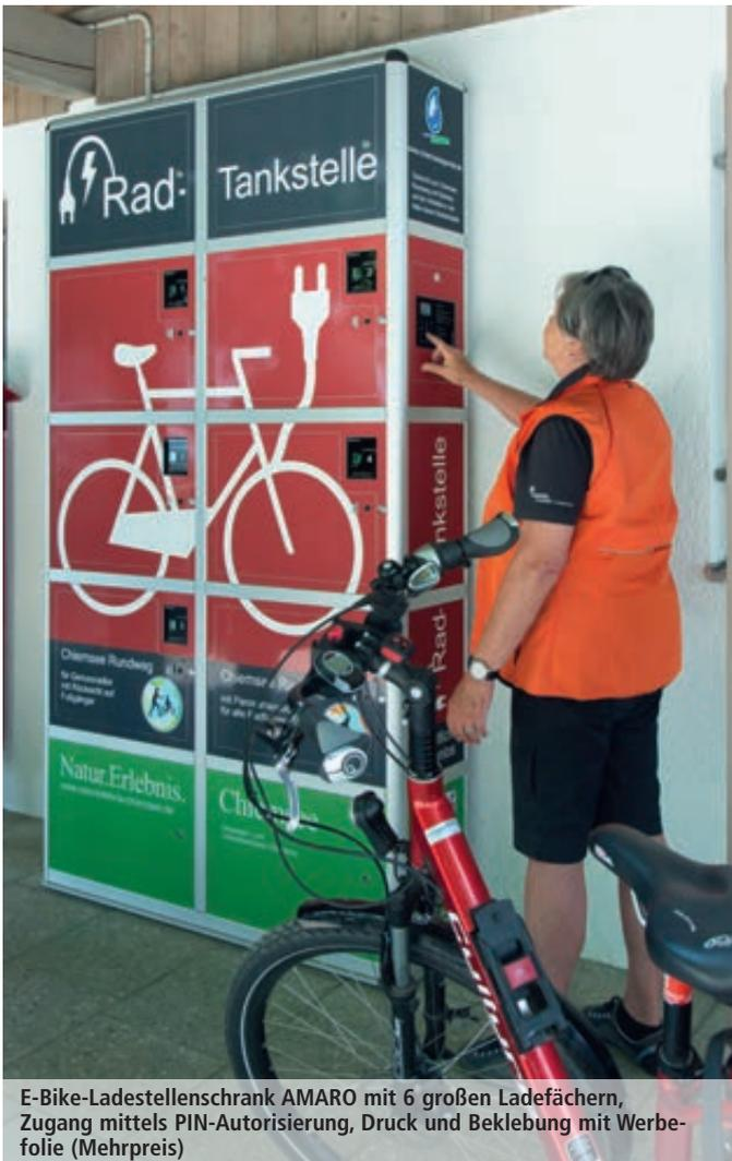
E-Bike-Ladestellenschrank AMARO mit 6 großen Ladefächern, Zugang mittels PIN-Autorisierung, Druck und Beklebung mit Werbe-folie (Mehrpreis)
