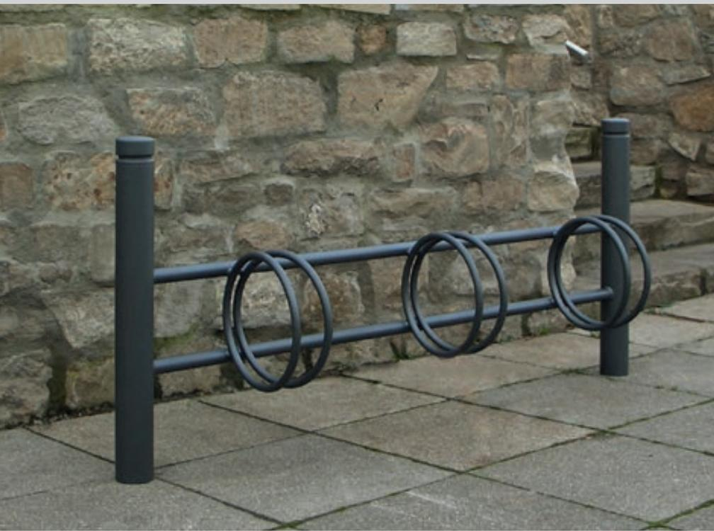
**Konstruktion:** Querholm aus Stahlrohr (Ø 34 mm), Haltebügel aus Rundstahl (Ø 18 mm). Mit 2 seitlichen Pollern aus Stahlrohr (Ø 83 mm), Höhe über Flur 600 mm.
