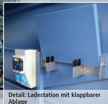
Detail: Ladestation mit klappbarer Ablage
