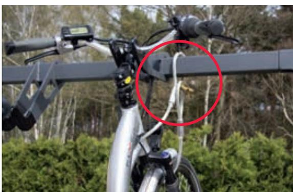
▲ Sicherungsseil zum sicheren Abschießen: durch das Vorderrad durchziehen und die Endschleife mit der Seilangfangschleife mittels bauseitigem Vorhängeschloss sichern
