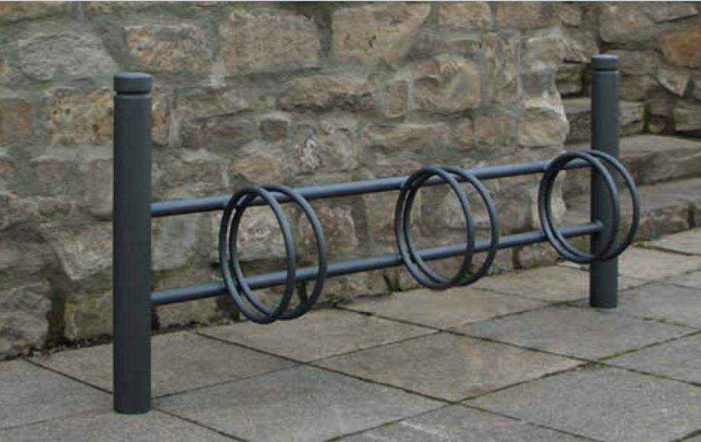
**Konstruktion:** Querholm aus Stahlrohr (Ø 34 mm), Haltebügel aus Rundstahl (Ø 18 mm). Mit 2 seitlichen Pollern aus Stahlrohr (Ø 83 mm), Höhe über Flur 600 mm.
