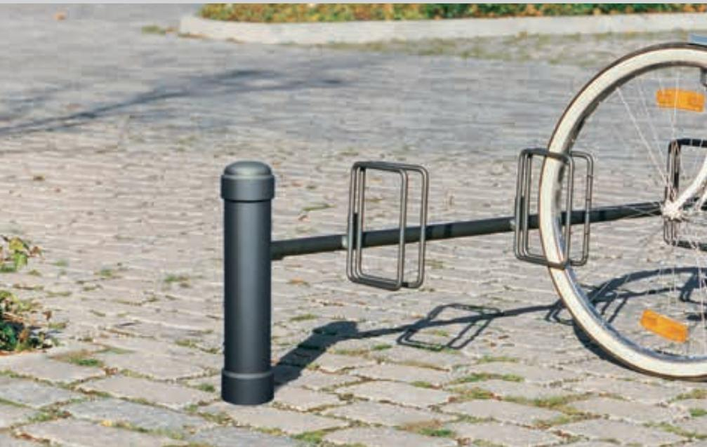
**Konstruktion:** Querholm aus Stahlrohr (Ø 34 mm), Haltebügel aus Rundstahl (Ø 12 mm). Mit 2 seitlichen Pollern aus Stahlrohr (Ø 76 mm).
