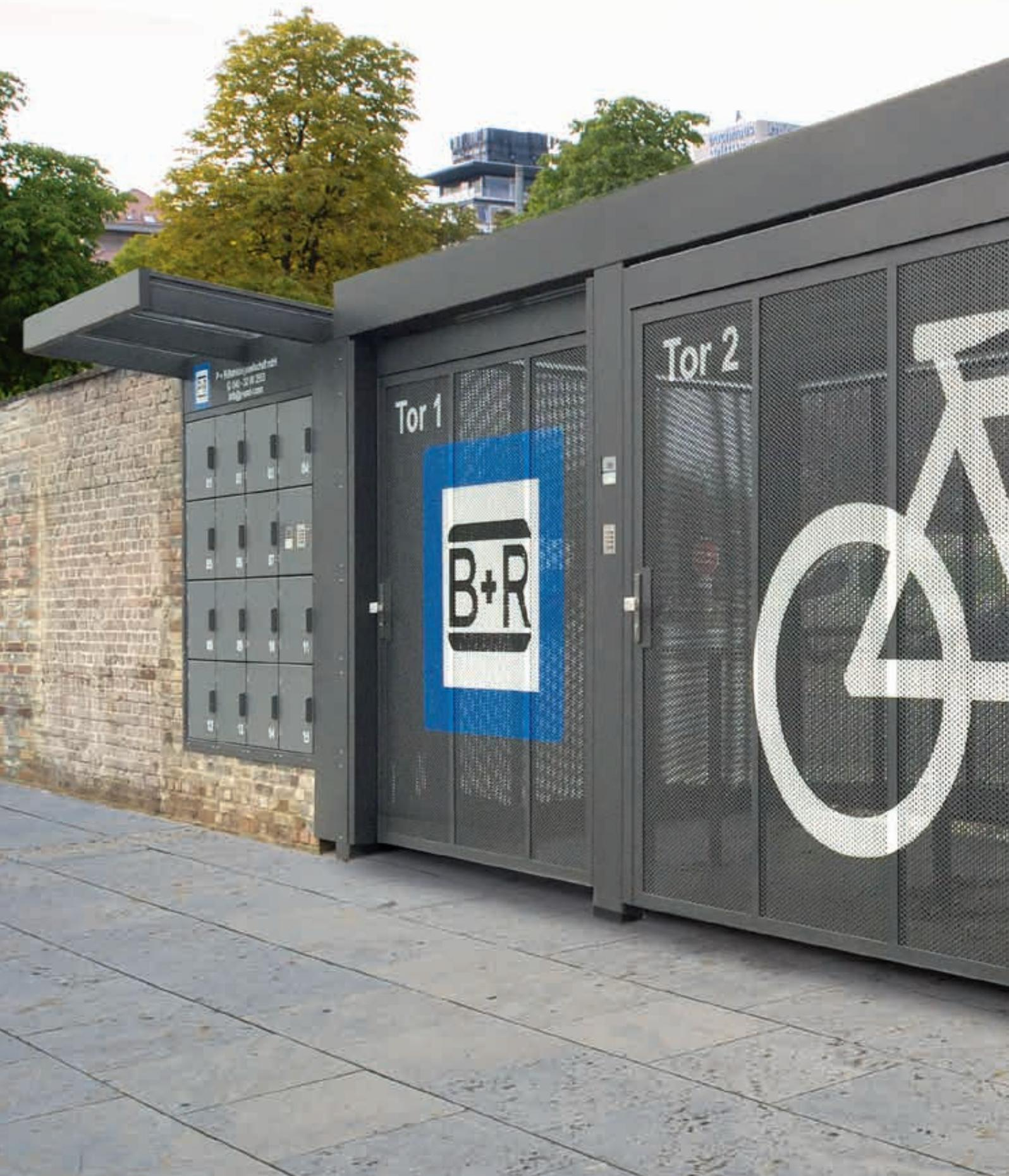
Fahradüberdachung MULTIPOST®-E, auftragsbezogene Anpassung, Dachbreite x Dachtiefe 9850 mm x 2580 mm, Wandelemente und Schiebetüren Lochblech, wachung STATION-CONTROL, Anlehnbügel ALSTER, Stahlkonstruktion RAL 7016 anthrazitgrau
