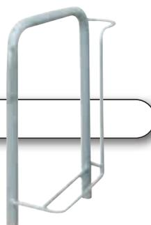
**Konstruktion:** Hauptbügel aus Rundrohr (Ø 33,7 mm) und Radeinstellung aus Rundstahl (Ø 14 mm). Diebstahlsichere Verschraubung aus Edelstahl mit Bodenrahmen. Bodenrahmen aus Trapezschielen. Durch Schrägstellung des Hauptbügels keine Berührung von lackierten Teilen des Fahrrades mit dem stabilen Hauptbügel. Geringe Anforderungen an die Oberfläche des Aufstellortes wegen guter Lastverteilung durch Trapezschielen, wenig „Tiefbau“ erforderlich. In den Trapezschielen sammelt sich kaum Schmutz.
