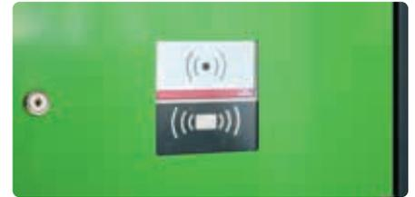
▲ Schließfachanlage SECURE, mit Zugang mittels RFID-Kartenleser
