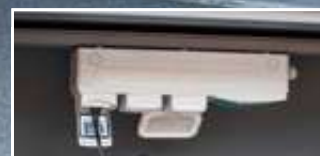
▲ Detail: Steckdosenleiste inklusive LED-Strahler und Dämmerungsschalter
