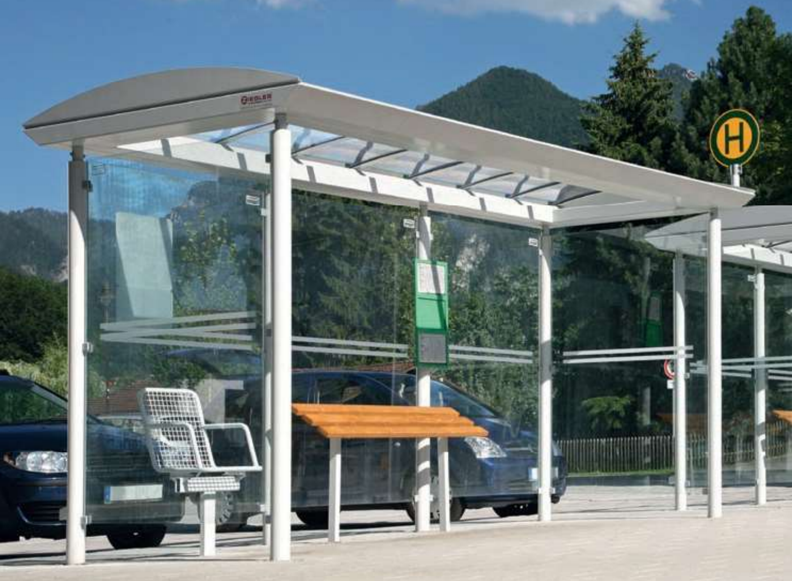
Wartehalle PLUTO, Dachbreite x Dachtiefe 4800 mm x 2030 mm, mit Rück- / Seitenwänden aus ESG, Klarglas mit Siebdruckstreifen, Drahtgittersitz TARVIS, Anlehnbank SMOKY, Stahlkonstruktion in RAL 7035 lichtgrau
