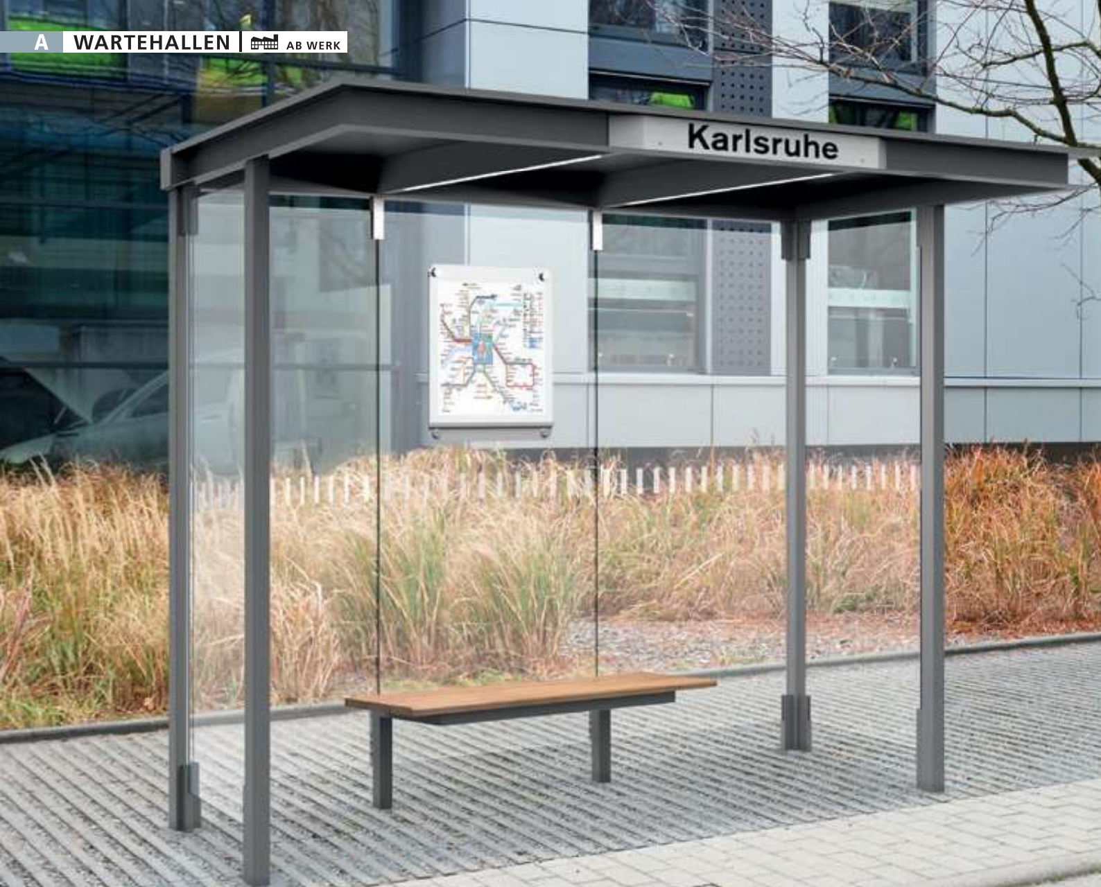
Wartehalle HOREC, Dachbreite x Dachtiefe 2955 mm x 1484 mm, mit Rück- und Seitenwänden Verbundsicherheitsglas (VSG), mit Sichtstreifen, Sitzbank mittig, Fahrplanschaukasten und LED-Beleuchtung, Stationsschild auftragsbezogene Anpassung in RAL 9016 verkehrsweis, Stahlkonstruktion in RAL 9007 grau aluminium
