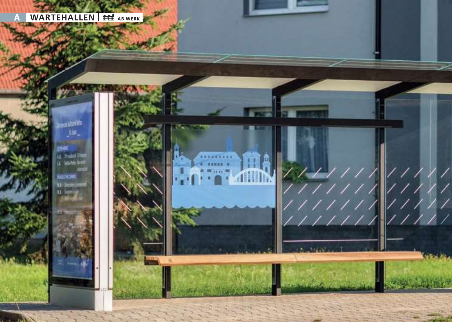
Wartehalle TRAXO, Dachbreite x Dachtiefe 5560 mm x 1740 mm, Rück- / Seitenwand ESG, Klarglas, mit Siebdruckdekor und bauseitiger Beklebung sowie Werbevitine, Abfallsammler (auftragsbezogen), Sitzbank Thermoholz Esche, Stahlkonstruktion in RAL 9005 tiefschwarz
