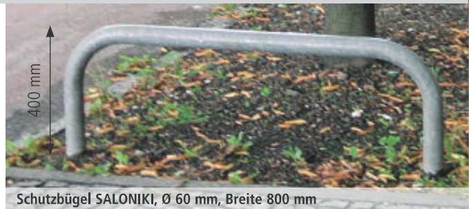
Schutzbügel SALONIKI, Ø 60 mm, Breite 800 mm
