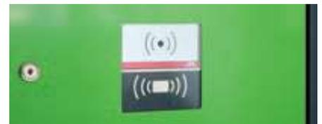
▲ Schließfachanlage SECURE, mit Zugang mittels RFID-Kartenleser
