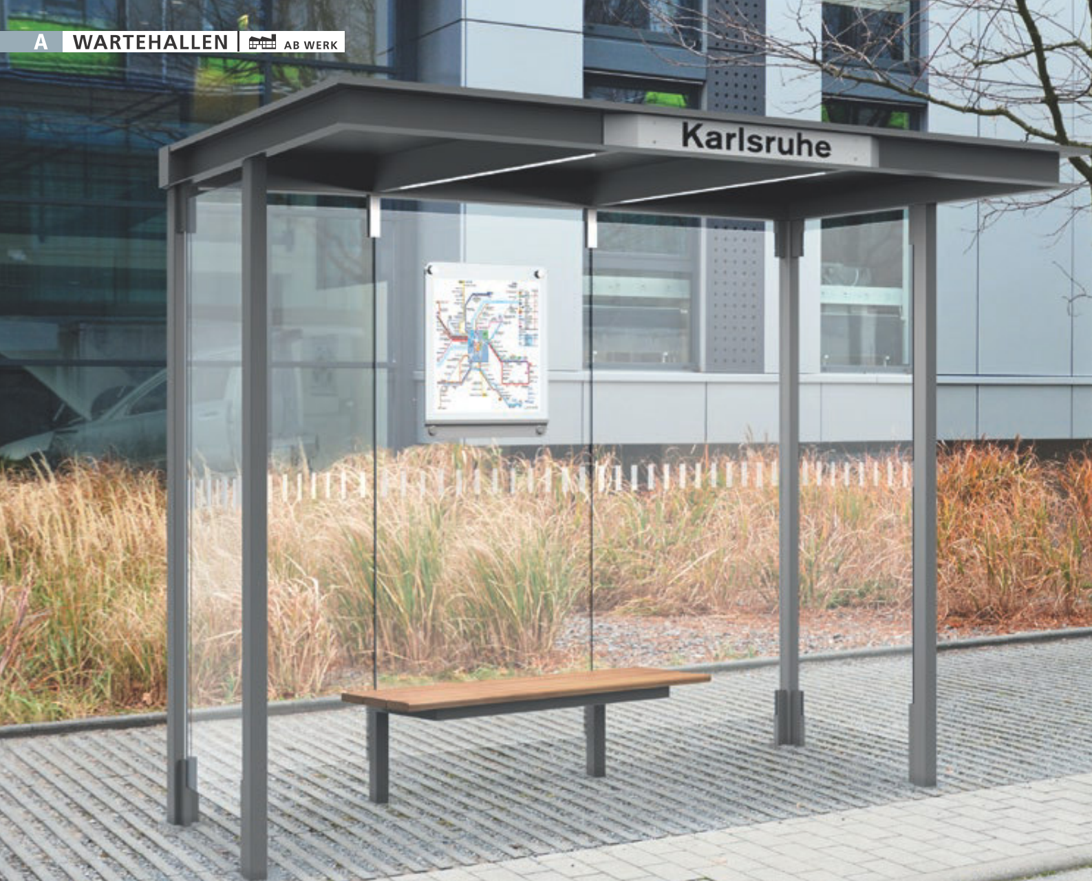
Wartehalle HOREC, Dachbreite x Dachtiefe 2955 mm x 1484 mm, Rück- / Seitenwände VSG, Klarglas, mit Sichtstreifen, Sitzbank mittig, Fahrplanschaukasten, LED-Beleuchtung, Stationsschild auftragsbezogene Anpassung in RAL 9016 verkehrsweis, Stahlkonstruktion in RAL 9007 graualuminiun
