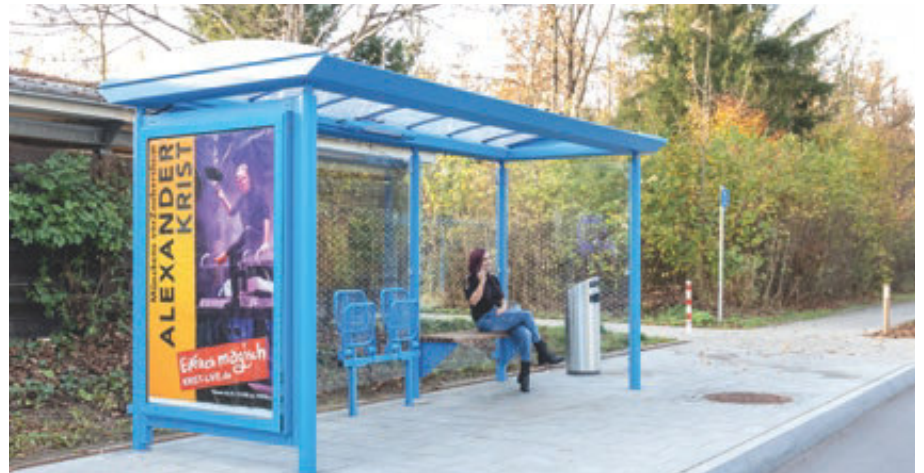
Wartehalle PLUTO, Dachbreite x Dachtiefe 4800 mm x 2030 mm, Rück- / Seitenwände ESG, Klarglas, mit Siebdruckpunkte, Werbevitrine CITY-LIGHT, Sitzbank ARES, Klappsitz TOLFA, Stahlkonstruktion in RAL 5015 himmelblau
