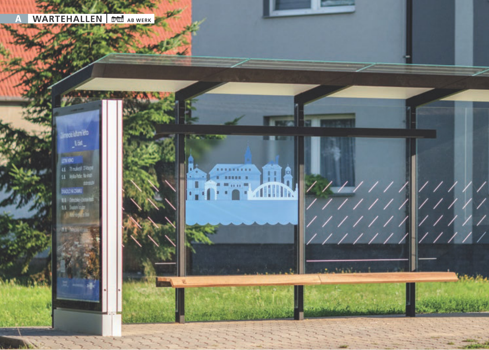
Wartehalle TRAXO, Dachbreite x Dachtiefe 5560 mm x 1740 mm, Rück- / Seitenwand ESG, Klarglas, mit Siebdruckdekor und bauseitiger Beklebung sowie Werbevitrine, Abfallsammler (auftragsbezogen), Sitzbank Thermoholz Esche, Stahlkonstruktion in RAL 9005 tiefschwarz
