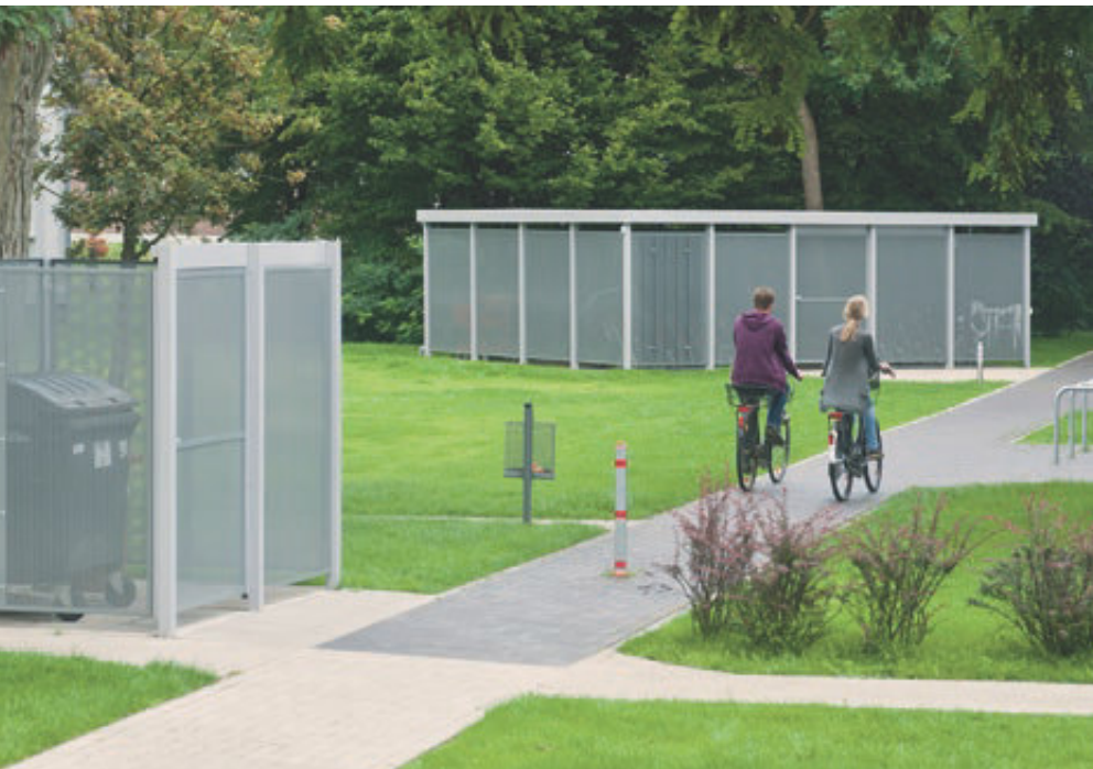
Überdachungsanlage FLEXI-BOX mit auftragsbezogener Anpassung, bestehend aus Fahrradüberdachung ca. Dachbreite x Dachtiefe 6300 mm x 7800 mm, Wandelemente und Schiebetüren, einteilig, mit Füllung aus Lochblech, Stahlkonstruktion in RAL 7005 mausgrau
