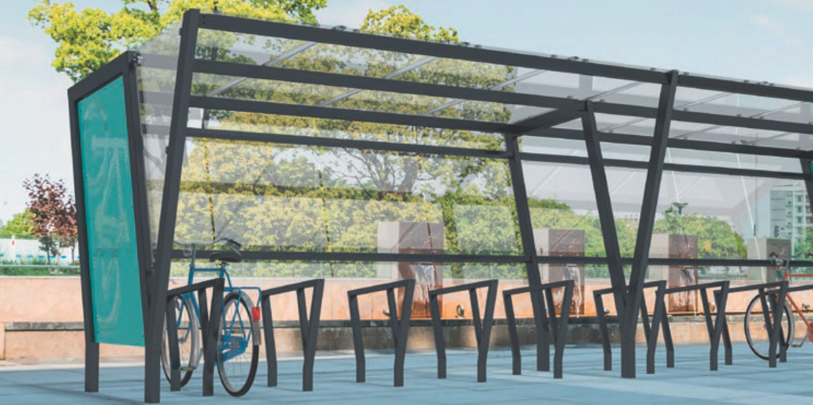
Fahrradüberdachung TAURI mit Pultdach, Dachbreite x Dachtiefe 7800 mm x 2500 mm, Rückwand ESG, Klarglas, Seitenwand Stahlblech perforiert und ESG, Klarglas, Dacheindeckung VSG, Klarglas, Fahrradanehnbügel TAURI, Stahlkonstruktion in RAL 7016 anthrazitgrau
