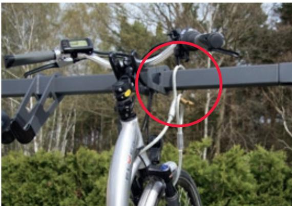
▲ Sicherungsseil zum sicheren Abschließen: durch das Vorderrad durchziehen und die Endschleife mit der Seilanfangsschleife mittels bauseitigem Vorhängeschloss sichern
