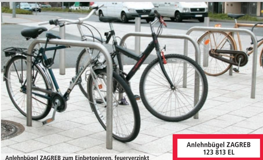
Anlehnbügel ZAGREB zum Einbetonieren, feuerverzinkt
