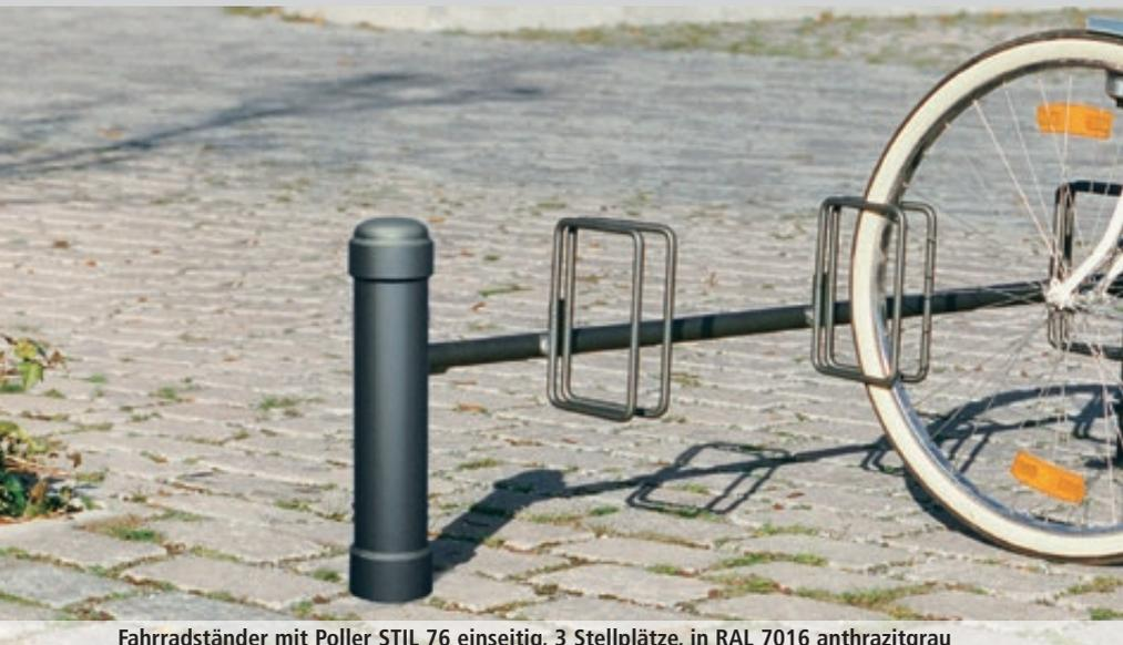
**Konstruktion:** Querholm aus Stahlrohr (Ø 34 mm), Haltebügel aus Rundstahl (Ø 12 mm). Mit 2 seitlichen Pollern aus Stahlrohr (Ø 76 mm).
