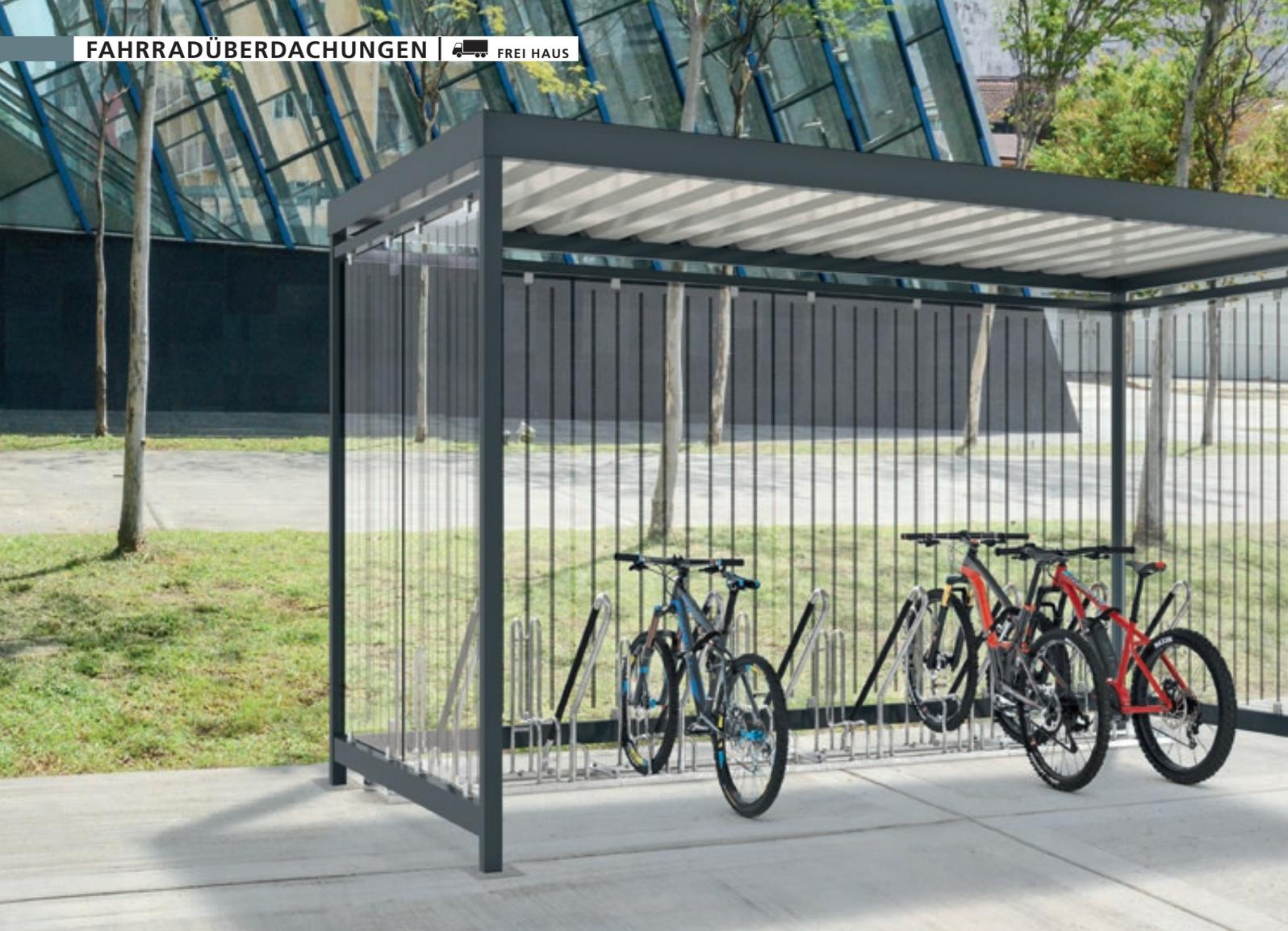
Fahrradüberdachung AQUILA, Dachbreite x Dachtiefe 4195 mm x 2165 mm, zum Aufdübeln bei -200 mm, Rück- / Seitenwände ESG, Klarglas inklusive Siebdruckdekor, Fahrradständer OAKLAND, Stahlkonstruktion in RAL 7016 anthrazitgrau
