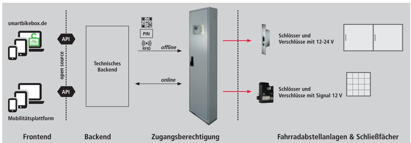
Die Internetplattform smartbikebox.de ist die Grundlage für eine intelligente Komplettlösung zur Steuerung von smarten ZIEGLER-Fahrradabstellanlagen und Schließfächern. Die Open-Source-Buchungsplattform – bestehend, aus einem Frontend zur Nutzerregistrierung, -verwaltung und zur Bezahlung – arbeitet mit einem technischen Backend der Stellplatz- und Standortverwaltung zusammen.
