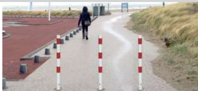
Sperrpfosten GERODA zum Einbetonieren, Ø 60 mm, herausnehmbar aus Bodenhülse mittels Dreikantschloss, feuerverzinkt und pulverbeschichtet
