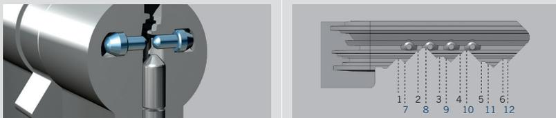
Zwei Schließreihen an einem Schlüsselverdoppeln das Schließgeheimnis (Abb.: ZRV6).
