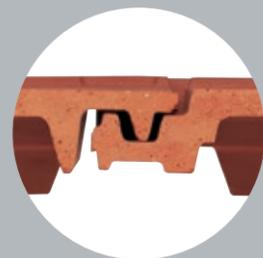
Vertikal ist Domino einmal verfalzt. Aber die besonders starke Tiefenausprägung bietet auch bei massiven Windeinflüssen eine optimale Wasserabführung. Treppenförmige Überdeckungen schützen vor dem Eindringen von Wasser und Schmutz.
