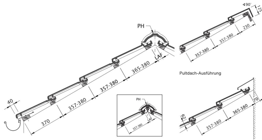
Dachquerschnitt Entlüftung über FALZ. Firstziegel trocken verlegt. LQ bis ca. 230 cm<sup>2</sup>/lfm First.
