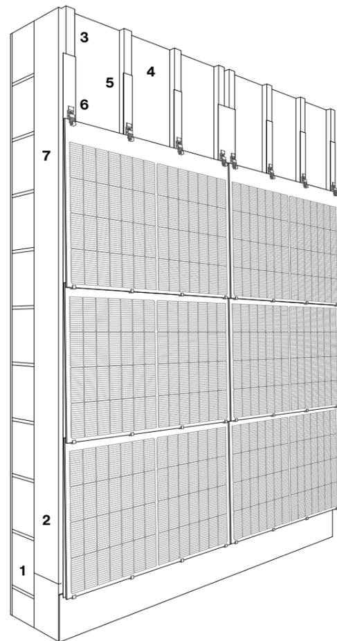
Aufbau des Sunskin Facade Lap Fassadensystems
