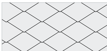
Einfachdeckung Rhombus Schablone 400 × 440 mm
