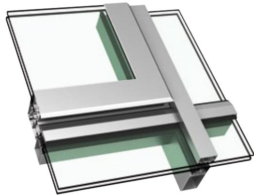
Die Qualitätsansprüche an einen Lüftungsflügel sind im Dachbereich besonders hoch. WICTEC 50 erfüllt diese bei gleichzeitig filigraner Optik mit minimiertem Glasebenenversatz. Schlanke Profilansichten, die verdeckt liegenden Bänder mit 90° Öffnungswinkel und die großen möglichen Flügelformate geben Ihnen eine große Gestaltungsfreiheit an die Hand. Durch die großen Lüftungsquerschnitte ist der Dachflügel WICTEC 50 auch für die Anwendung als NRW ideal.
