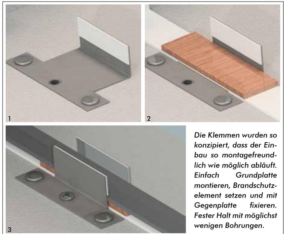
Die Klemmen wurden so konzipiert, dass der Einbau so montagefreundlich wie möglich abläuft. Einfach Grundplatte montieren, Brandschutzelement setzen und mit Gegenplatte fixieren. Fester Halt mit möglichst wenigen Bohrungen.
