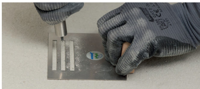
Ritzprobe per Ri-Ri-Gerät und Schablone
