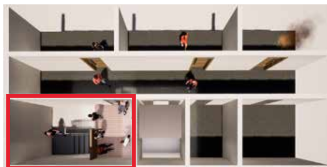
Sicherere Verweilbereich im ausreichend großen Fluchttreppenhaus
