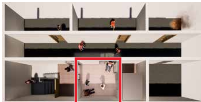
Sicherere Verweilbereich zwischen Feuerwehraufzug und Fluchttreppenhaus
