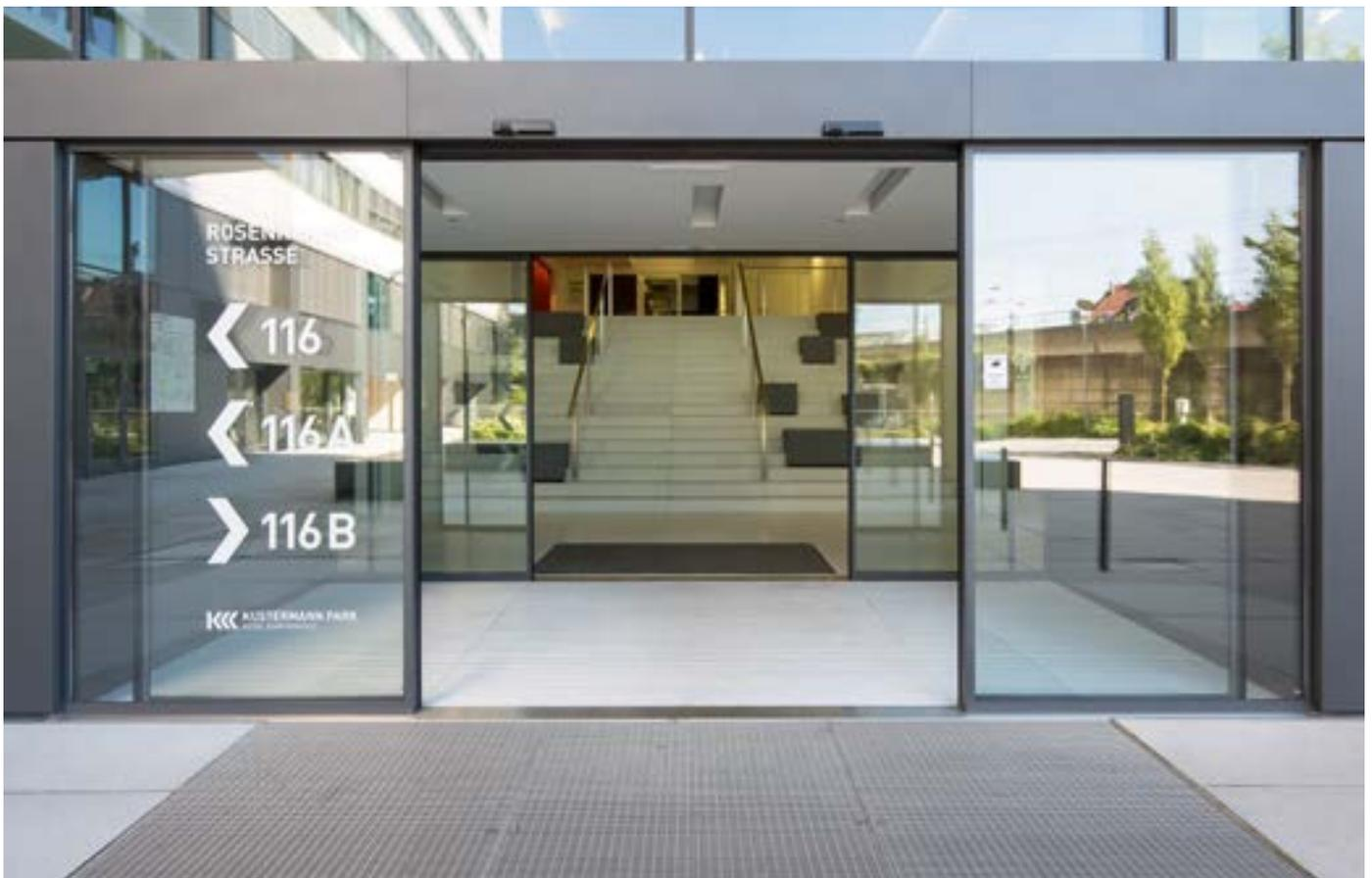
Einbruch- und Vandalismus-Schutz bei dezenter Optik sind die Kernmerkmale der Schiebetür FLEX SECURE. Die Einbruchschutzklassen WK2/RC2 sind durch einen Prüfnachweis nach EN 1627 ff. belegt. In Kombination mit den Türtypen ST FLEX oder ST FLEX Green sind transparente, barrierefreie Eingangslösungen einfach realisierbar.
