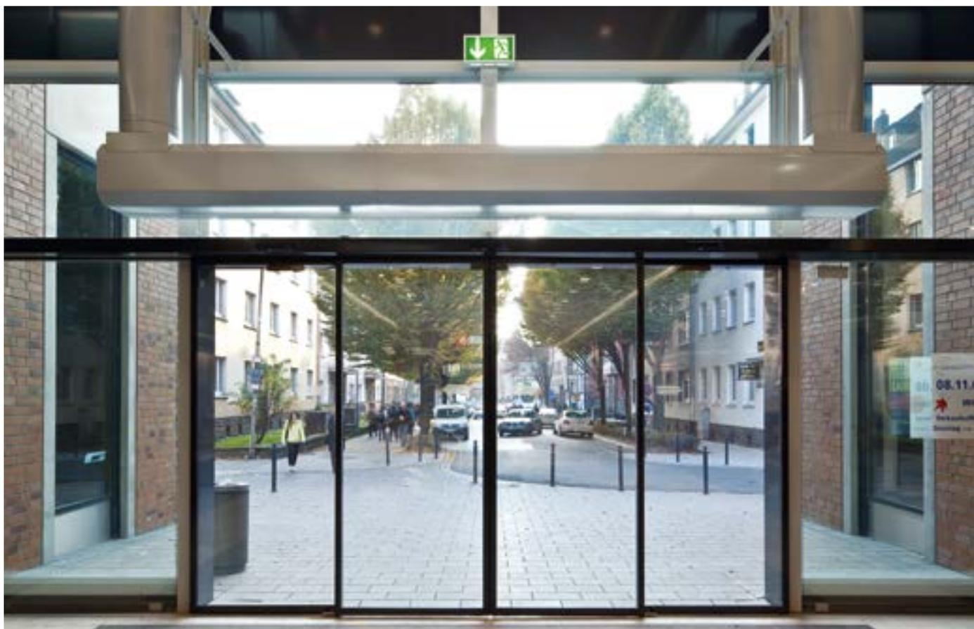
Aufschwenkbare Türflügel und Seitenteile können im Gefahrenfall sehr große Durchgangsweiten freigeben. Im Automatikbetrieb arbeitet die Schiebeschwenktür wie eine Standard-Schiebetür.
