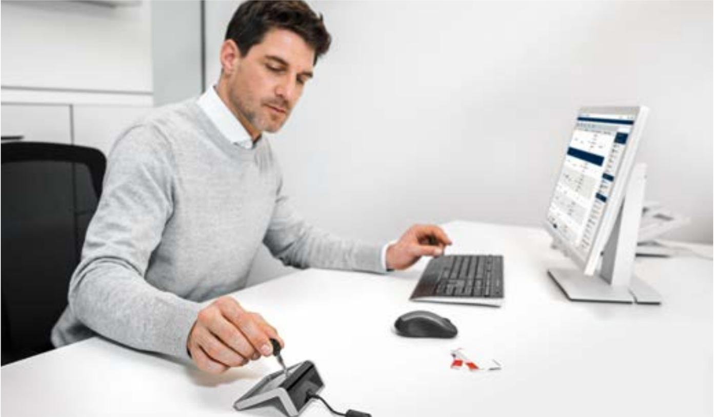
Der dormakaba Tischleser 91 08 dient zum Auslesen und Beschreiben von RFID-Medien in Form von Karten, Smartkeys oder Schlüsselanhängern, die in der Zeiterfassung oder Zutrittskontrolle eingesetzt werden. Der Tischleser wird über seine USB-Schnittstelle an einen PC angeschlossen. Das Gerät wird von Windows automatisch erkannt und installiert.
