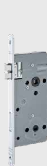
127/WC mit Kurbelfalle Stulp 250x18x4 mm
