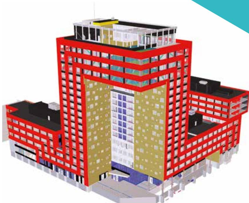
CON Växjö ist 67 Meter hoch und beherbergt ein Hotel, Apartments, Büros, Gastronomie und eine Schule mit einer Gesamtfläche von 37.000 m<sup>2</sup> auf 20 Geschossen. Peikko lieferte die Verbundkonstruktion und den Stahlskelettbau für dieses Projekt und ist für die Standsicherheit des gesamten Gebäudes mit verantwortlich.
