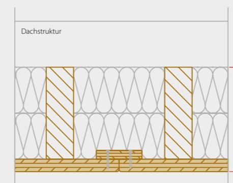
BEISPIEL – DACHKONSTRUKTION (R 300)
