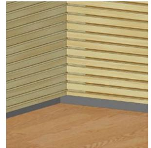
Abschlussdetail des akustischen Paneels 50 mm über dem Fußboden
