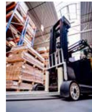
In Hochregallagern, die heute meist automatisiert bedient werden, muss eine ausreichende Ebenheit zur Verhinderung von Schwankungen der Fahrzeuge erreicht werden. Nach DIN 15185 darf bei einer Flurförderzeug-Hubhöhe größer 6,01 m und Automatikbetrieb der Höhenunterschied bei einem Meter Fläche nur 1,5 mm betragen. Die Nivellierung der **VIASOL** Industriebodensysteme besteht durch ihre sehr gute Verlaufsbarkeit und garantiert eine präzise Ebenheit.
