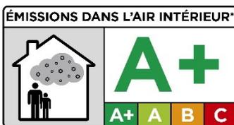
Holzwoleplatten von Fibrolith wurden nach der französischen VOC-Verordnung Décret-No. 2011-321 auf die Emission flüchtiger Schadstoffe geprüft und erfüllte alle Prüfkriterien für die Klassifizierung A+. Eine separate Messung für Formaldehyd ergab die Klassifizierung E1.
