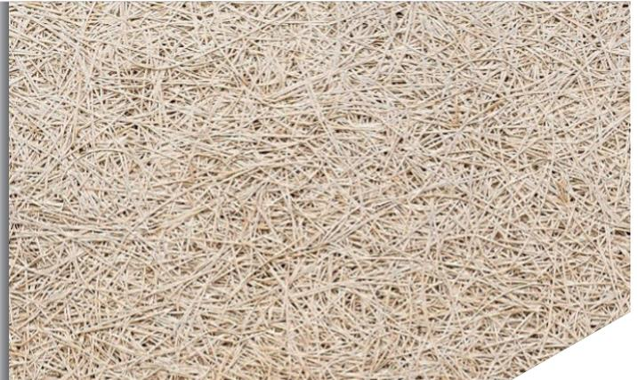
Die Fibro Kustik Barcelona DUO ist eine Mehrschichtplatte aus einer mineralisch gebundenen Holzwollschicht mit Steinwollekern zur Verbesserung der Raumakustik mit einer Faserbreite von 1 mm und Brandschutzklasse B-s1, d0. Für die Herstellung wird neben Weißzement und Steinwolle nur Fichtenholz aus PEFC- bzw. FSC<sup>®</sup>-zertifizierter Waldwirtschaft verwendet, wodurch eine nachhaltige Lieferkette des natürlichen Rohstoffes Holz garantiert wird.
