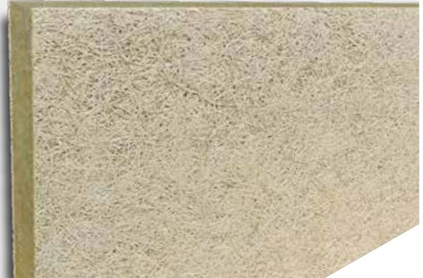
Die Fibro THERM-S 3 N – 040 B1 ist eine Mehrschichtplatte aus zwei mineralisch gebundenen Holzwollschichten mit Steinwollekern für die thermische Dämmung mit schallschluckender Wirkung mit der Brandklasse B-s1, d0. Für die Herstellung wird neben Weißzement und Steinwolle nur Fichtenholz aus PEFC- bzw. FSC®-zertifizierter Waldwirtschaft verwendet, wodurch eine nachhaltige Lieferkette des natürlichen Rohstoffes Holz garantiert wird.
